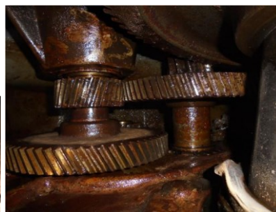
Fig. 3 – Interior do redutor de acionamento do agitador
